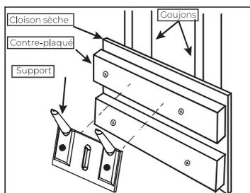
Figure - Montage pour cloison sèche
